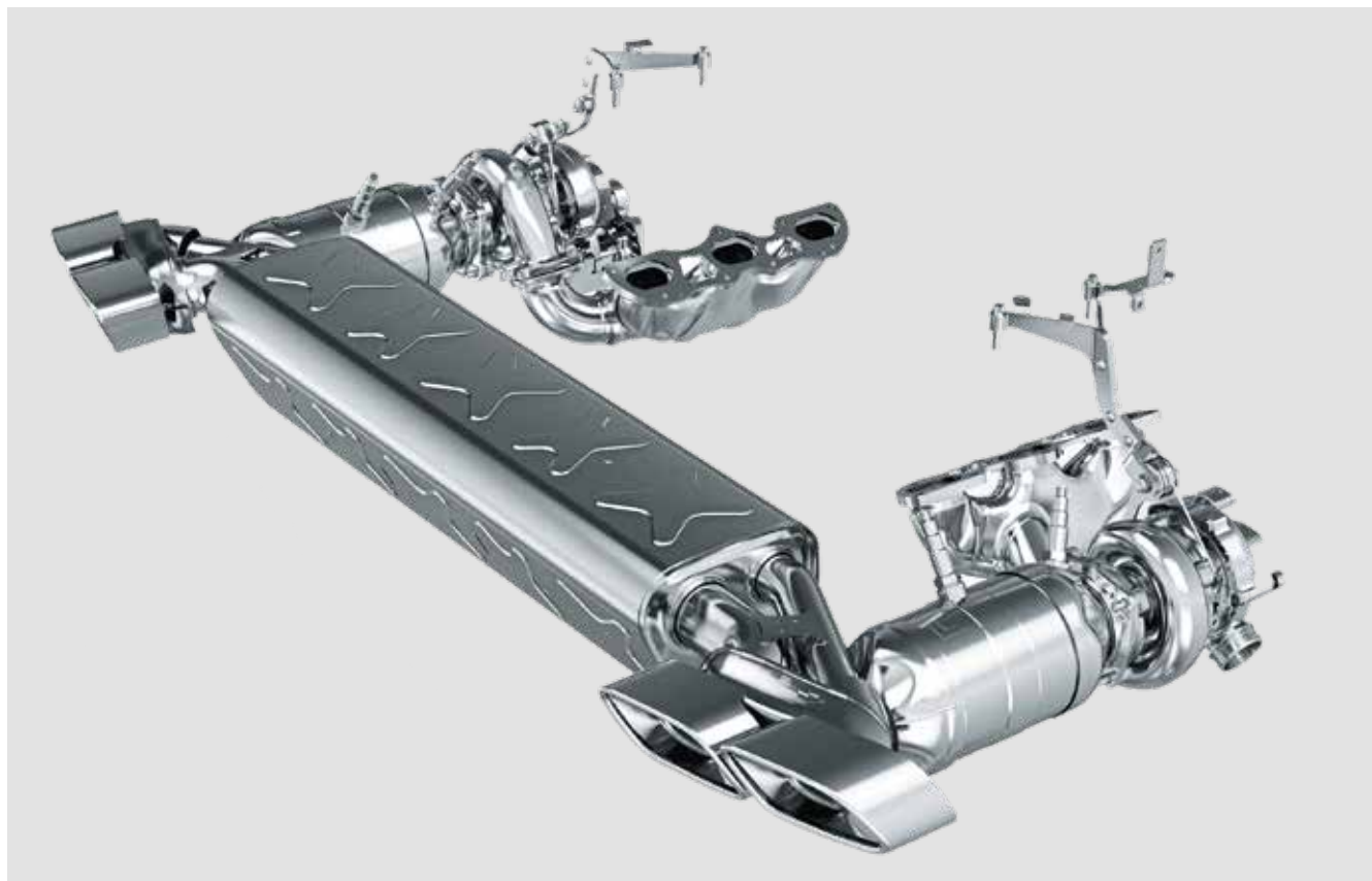
Das aktuelle Abgassystem eines Porsche Carrera Turbo – ausgelegt auf die Bauraumanforderungen im Heck – mit jeweils zwei Krümmern und Katalysatoren sowie dem Hauptschalldämpfer samt Endrohren.
